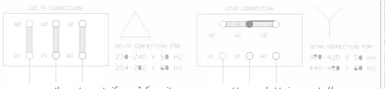
Il motore trifase è fornito con connettore elettrico a stella
